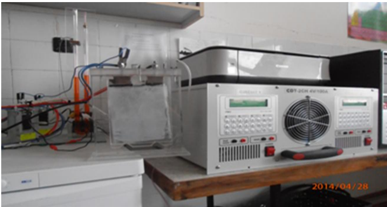
Специализирана апаратура (разработена в България) за тестване на никел-цинкови клетки
