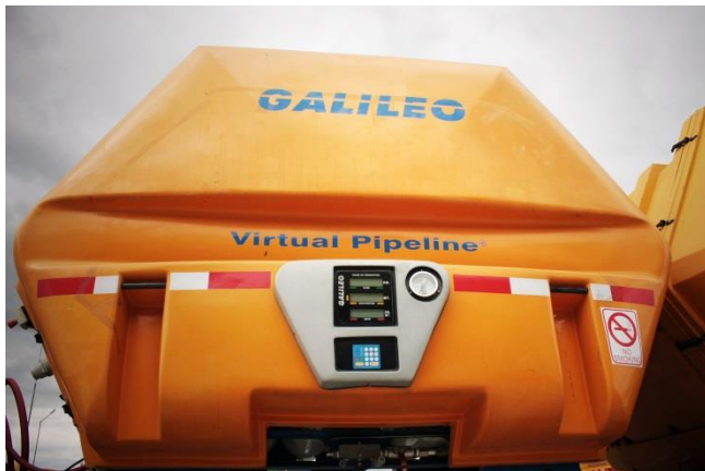
МЕГК с вграден компресор и зарядна колонка за допълване на газ
