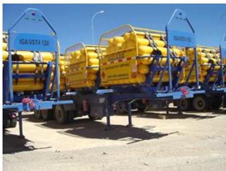
Фиксирани към полуремърке МЕГК – MAT фикс,
